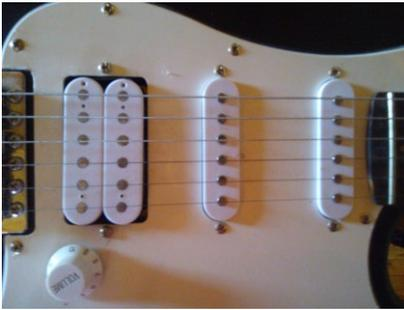
E-Gitarren haben meist Abnehmer-Spulen: Single-Coil oder Humbucker (Doppelspulen-System). Im Bild ist links der Humbucker und rechts zwei Single-Coils zu sehen. Humbucker sind konstruktionsbedingt unempfindlich gegen elektromagnetische Einstreuungen, Single-Coils aber sind empfindlich darauf. Bei Single-Coils könnte es in
