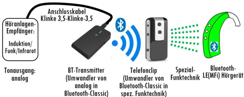
Manche Bluetooth-Transmitter geben um Umkreis von etwa 15cm ein Störsignal ab, das in einen Induktions- oder Funk/Infrarot-Empfänger einstreut. Dann müssen die Geräte etwa 15-30cm auseinandergehalten werden. Hier gibt es hohen Latenzzeit bis zu 260ms.
